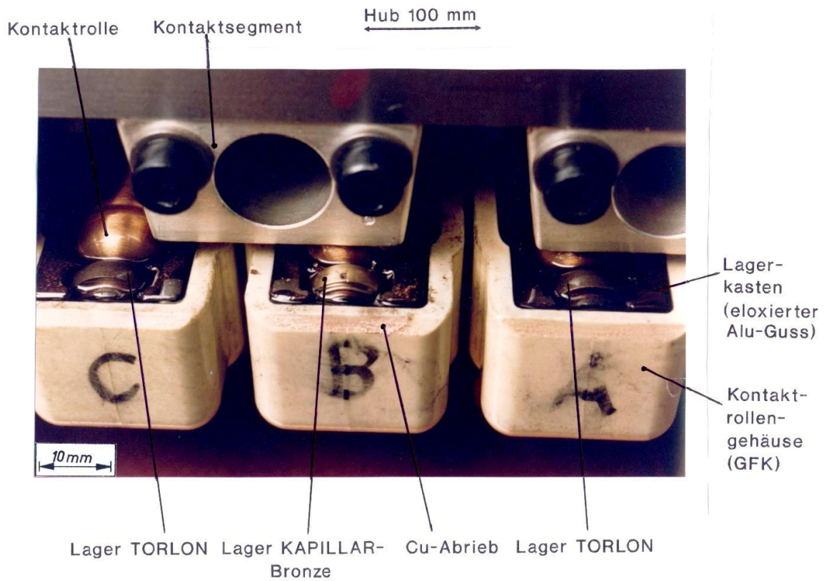
Prüfaufbau: Detailansicht Kontaktrolle-Kontaktsegment
