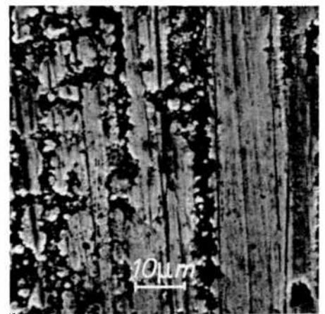
14: St. 8550 ionitriert, Verschleiß von 0,6 mg/cm 2 durch SAN - 35 % GF. Aufnahme mit dem Raster-Elektronenmikroskop. Schleifrichtung vertikal, Strömungsrichtung horizontal — Type 8550 steel ionitriated. Wear of 0.6 mg/cm 2 caused by SAN with 35 % of glass fibres. Scanning electron microscope photograph. Direction of grinding: vertical; direction of flow: horizontal — Acier 8550 nitruré par échange d'ions, usure de 0,6 mg/cm 2 par SAN - 35 % fibre de verre. Photographié à l'aide d'un microscope électronique à balayage. Direction de l'abrasion: verticale; direction de l'écoulement: horizontale
