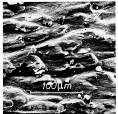
13: St. 7011, Verschleiß von 8,3 mg/cm 2 durch 6,6 PA - 35 % GF. Aufnahme mit dem Raster-Elektronenmikroskop. Schleifrichtung vertikal, Strömungsrichtung horizontal — Type 7011 steel. Wear of 8.3 mg/cm 2 caused by nylon 66 with 35 % glass fibres. Scanning electron microscope photograph. Direction of grinding: vertical; direction of flow: horizontal — Acier 7011, usure de 8,3 mg/cm 2 par la PA 6,6 - 35 % fibre de verre. Photographié à l'aide d'un microscope électronique à balayage. Direction de l'abrasion: verticale; direction de l'écoulement: horizontale
