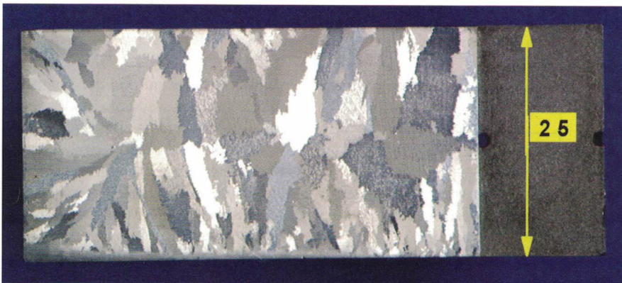
Bild 4. MarM247-Gefüge bei großen Querschnitten
