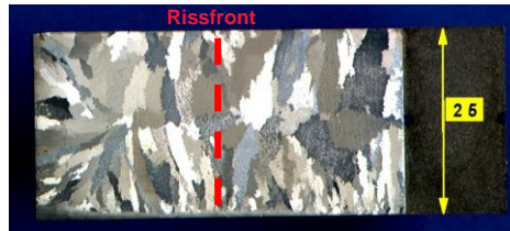
Schliff durch 1"-CT-Probe
